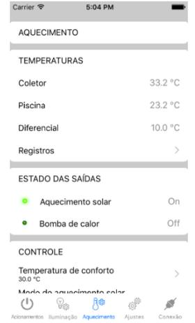
Na seção TEMPERATURAS são exibidas as temperaturas atuais do controle de temperatura e no item "Registros" é possível visualizar os registros diários das temperaturas mínimas e máximas alcançadas.
